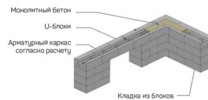
Схема изготовления армопояса из U-блоков «ЭКО»
